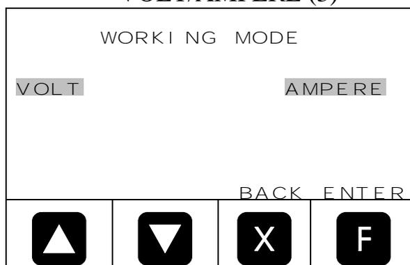
Si sceglie il funzionamento in Volt o Ampere con i tasti a freccia: con il tasto F si acquisisce l'impostazione
