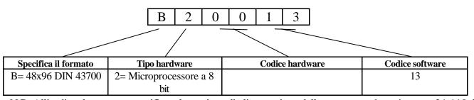
N.B. All'ordine deve essere specificata la tensione di alimentazione dello strumento che può essere 24-110-220 VAC e la configurazione degli ingressi (NPN o PNP)
