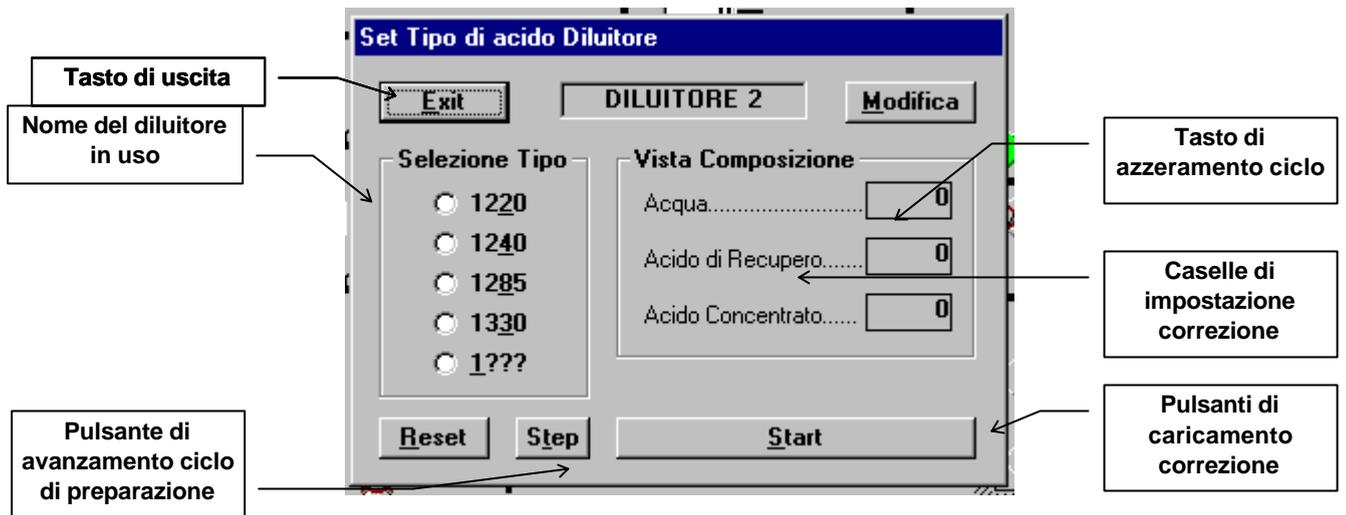
Al termine del caricamento (acido diluito e/o acqua e Acido concentrato) si apre la finestra di correzione diluizione.
